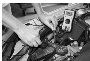
Prueba de batería
