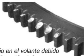
Daño en el volante debido a alineación defectuosa.
