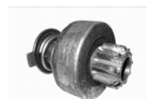
Daño del disco del iniciador debido a alineación defectuosa.
