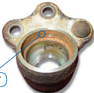
CORROSIÓN EN LA CAJA, PRUEBA DE ENTRADA DE CONTAMINACIÓN
