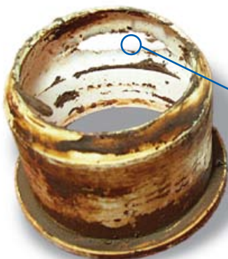
COJINETE DESGASTADO, DEFECTUOSO
