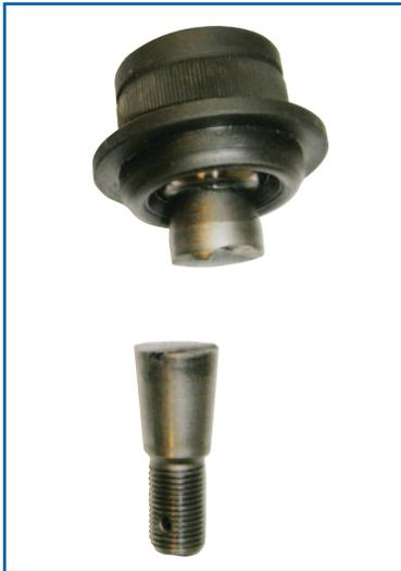
PASADOR DE UN PROVEEDOR ALTERNATIVO, RAJADO DEBIDO A UN TRATAMIENTO TÉRMICO INADECUADO.
