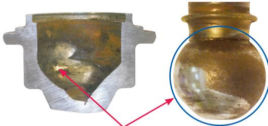
La pièce d'origine offrait un jeu de 0,080 po en raison de la défaillance du roulement. Résultat, le boîtier et les composantes du joint à rotule non trempés s'usent l'un dans l'autre.
