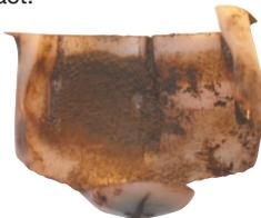
**NOTE:** Roulement en polymère du même style que l'équipement d'origine détérioré en raison de conditions d'utilisation difficiles.
