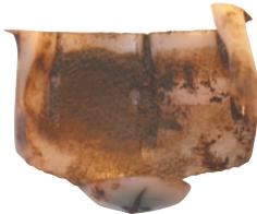
**NOTA:** Cojinete de polímero de tipo original deteriorado debido a las condiciones de uso difíciles.
