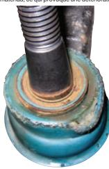
Note: Les gaines de couleur bleue ne sont pas toutes créées égales. Les gaines MOOG de type soufflet (utilisées sur d'autres produits MOOG) sont de couleur bleue, mais sont fabriquées à partir d'uréthane de qualité supérieure. Ces gaines ne se détériorent pas comme le polychloroprène bleu.
