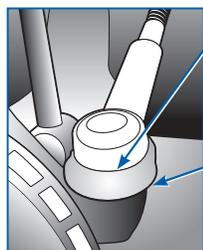
El agua se queda atrapada en el borde de la funda guardapolvo y se filtra por el anillo de retención. Inspección: El vehículo debe estar sobre el suelo. Haga que un ayudante gire el volante a un lado y a otro. Observe el movimiento de los terminales de dirección. Debe sustituirse todo terminal que muestre signos perceptibles de movimiento.
