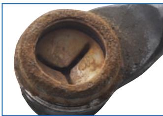
El diseño plástico no reparable ha fallado a causa de la intrusión y el desgaste.
