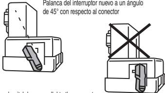
FIG. 1 New switch lever at 45° angle to connector Manette du nouvel interrupteur positionnée à un angle de 45° par rapport au raccord Palanca del interruptor nuevo a un ángulo de 45° con respecto al conector
