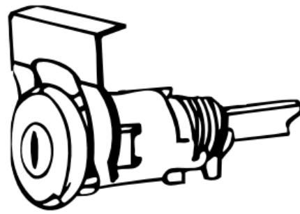
Totalmente armada, lista para instalar. El clip de sujeción encaja hacia arriba y abajo, tal como se ilustra. Además, debe ubicarse en la tapa del compartimiento de equipaje, no en la carrocería.
