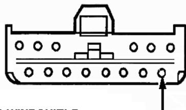
HEATED WINDSHIELD CONTROL MODULE CONNECTOR
