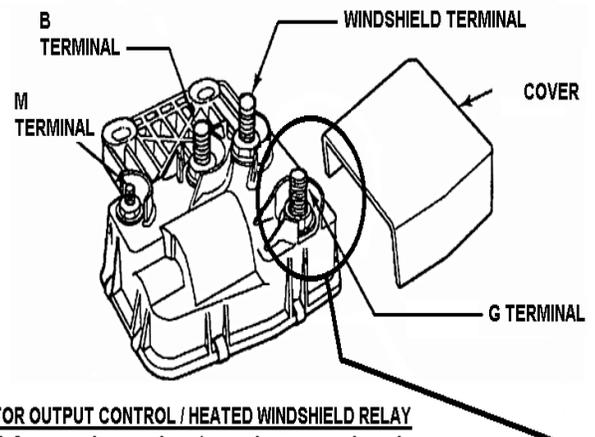
ALTERNATOR OUTPUT CONTROL / HEATED WINDSHIELD RELAY
